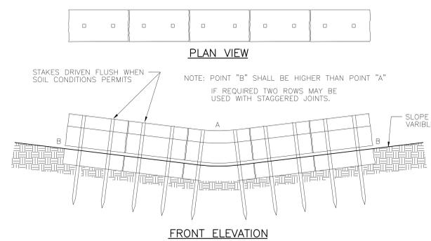
3B EROSION BALES ACROSS DITCH BOTTOM
