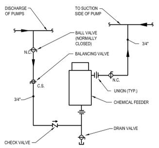
**12** CHEMICAL FEEDER PIPING DETAIL
