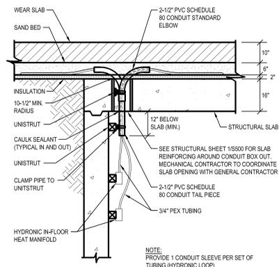
**11** IN-FLOOR SLAB PENETRATION DETAIL
