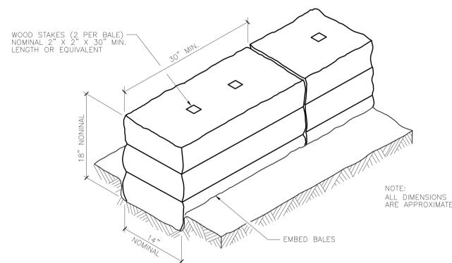
3A DETAIL OF EROSION BALE INSTALLATION
