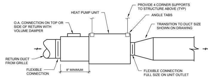
**3** HEAT PUMP UNIT DUCT CONNECTION DETAIL
