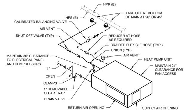
**1** HEAT PUMP UNIT PIPING DETAIL
