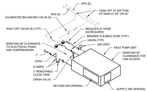
**2** HEAT PUMP UNIT PIPING DETAIL
