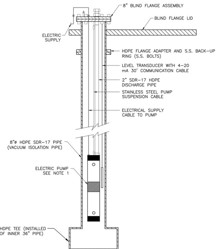
**ELECTRIC PUMP ASSEMBLY FOR CONDENSATE KNOCKOUT**
