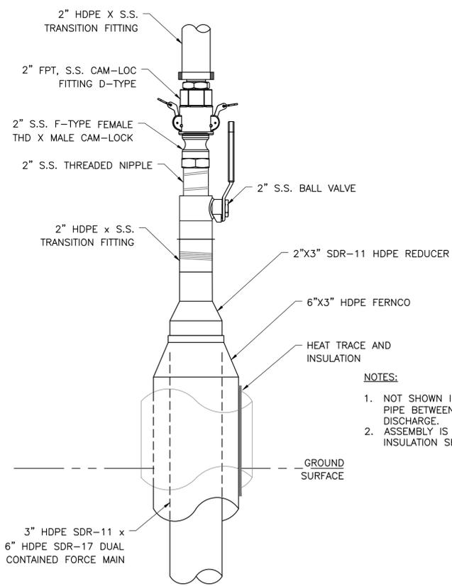
**TYPICAL PUMP DISCHARGE ASSEMBLY TO FORCE MAIN**
